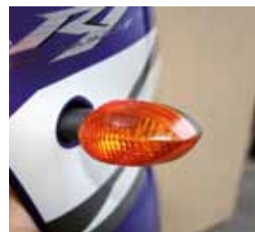
Etape 1 : Retirer le clignotant d'origine. Remove OE indicator light.
