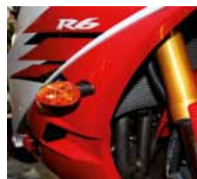
Etape 1 : Retirer le clignotant d'origine. Remove OE indicator light.
